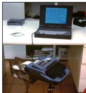
Figura 2. Máquina de estenotipia conectada a un ordenador
